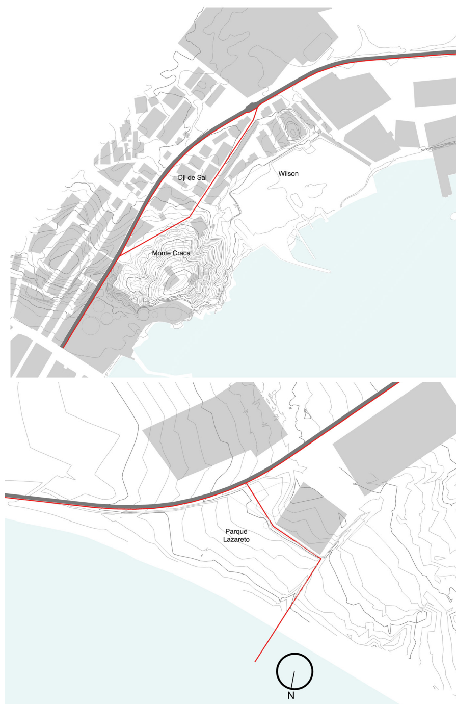
Figura 61 – Alteração do traçado da ciclovia e do percurso pedonal.
