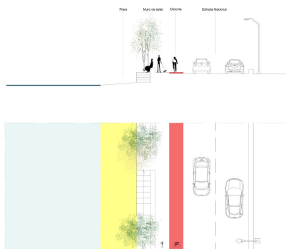
Figura 65 – Corte e planta da intervenção (i3).
